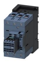
contacteur ferroviaire, AC-3e/AC-3, 95 A, 45 kW / 400V, 3 pôles, 110 V DC, 0,7-1,25\* US, mécanisme de commande électronique avec varistance intégrée, contacts auxiliaires : 2 NO + 2 NF, circuit principal : borne à vis, circuit de commande et de courant auxiliaire : borne à ressort, taille : S3, bloc de contacts auxiliaires amovible
