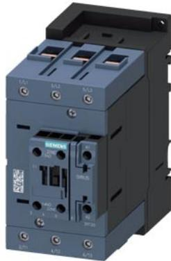
contacteur ferroviaire, AC-3e/AC-3, 110 A, 55 kW / 400 V, 3 pôles, 110 V DC, 0,7-1,25\* US, mécanisme de commande électronique avec varistance intégrée, contacts auxiliaires : 1 NO + 1 NF, borne à vis, taille : S3
