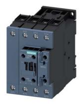
Contacteur, 1 CA, 110 A/400 V/40 °C, S2, 4 pôles, 110V CA/50Hz, 1 NO +1 NF, borne à vis
