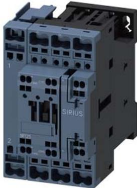
Contacteur de puissance, AC-3 25A, 11 kW / 400 V 2 NO + 2 NF 220 V CC, 50 Hz 240V, 60 Hz, 1 NO + 1 NF 4 pôles taille S0 borne à ressort 1 NO + 1 NF intégrés
