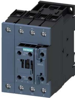
Contacteur de puissance, AC-3 50A, 22 kW / 400 V 2 NO + 2 NF AC 24 V, 50 Hz 4 pôles taille S2 borne à vis 1 NO + 1 NF intégrés
