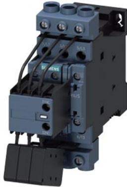
Contacteur de condensateur, AC-6b 33 kVAr, / 400 V 1 NO + 2 NF, DC 110 V 3 pôles, taille S0 borne à vis
