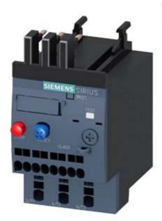
Relais de surcharge 4,5...6,3 A thermique pour protection des moteurs taille S00, Class 10 Montage sur contacteur circuit principal : bloc de jonction à bornes à ressort Circuit auxiliaire : borne à ressort Réarmement automatique/manuel
