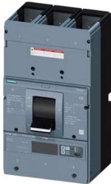
disjoncteur 3VA6 UL Frame 1200 pouvoir de coupure classe M 35kA à 480 V 3 pôles, protection des lignes ETU860, LSIG, In=1000A protection contre les surcharges Ir=400A - 1000A protection contre les courts-circuits Isd=0,6-10x In, Ii=1,5-12x In sans coupleur
