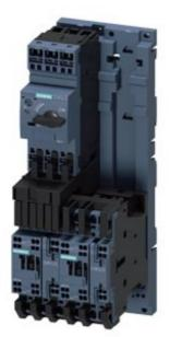
partenza senza fusibili, funzionamento con inversione AC 400 V, grandezza costruttiva S0 16 ... 22 A DC 24 V morsetti a molla per montaggio su guida DIN con adattatore per guida DIN (conformemente anche al tipo di coordinamento 1) tipo di coordinamento 2, Iq = 150 kA 1 NO+1 NC (contattore)
