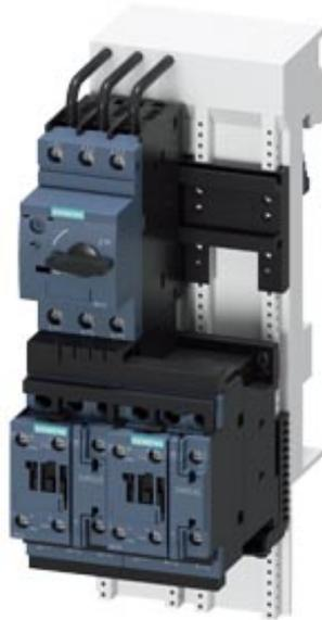
partenza senza fusibili, funzionamento con inversione AC 400 V, grandezza costruttiva S0 23,0 ... 28,0 A AC 230 V morsetti a vite per sistema a sbarre colletttrici 60 mm (conformemente anche al tipo di coordinamento 1) tipo di coordinamento 2, I<sub>q</sub> = 150 kA 1 NO+1 NC (contattore)
