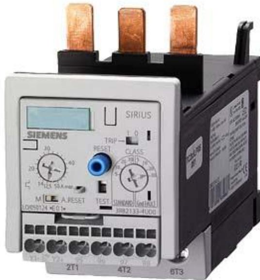
relè di sovraccarico 6 ... 25 A per protezione motore grandezza costruttiva S2, classe 5...30 montaggio separato circuito principale: trasformatore a foro passante circuito ausiliario: morsetto a molla reset manuale-automatico rilevamento di guasto verso terra interno !!! Prodotto di fine serie !!! Il successore è SIRIUS 3RB3 II successore consigliato è >>3RB3123-4QE0<<
