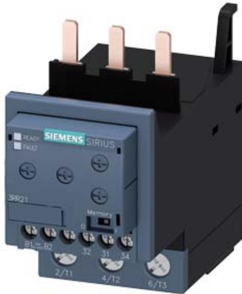
relè di controllo, applicabile al contattore 3RT2, grandezza costruttiva S2 Basic, a impostazione analogica sorveglianza di corrente apparente 8...80 A, 50...60 Hz, Bifase alimentazione AC/DC 24 ... 240 V 1 contatto CO controllo di superamento in positivo e in negativo della corrente mancanza di fase, rottura conduttore con o senza memorizzazione errore ritardo all'avvio 0-60 s soppressione picchi di interferenze 0-30 s isteresi di commutazione 6% tecnica di collegamento a vite
