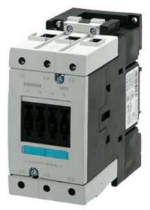
contattore di potenza, AC-3 95 A, 45 kW / 400 V AC 110 V, 50 / 60  $\,$ Hz a 3 poli, grandezza costruttiva S3 morsetto a vite !! Prodotto di fine serie !!! Il successore è SIRIUS 3RT2 Il successore consigliato è >>3RT2046-1AG20<<
