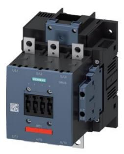
contattore di potenza, AC-3 185 A, 90 kW / 400 V AC (50...60 Hz) / comando in DC UC 110 ... 127 V contatti ausiliari 2 NO + 2 NC laterali, non rimovibili a 3 poli, grandezza costruttiva S6 attacchi a sbarra azionamento: convenzionale
