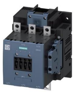
contattore di potenza, AC-3 185 A, 90 kW / 400 V AC (50 ... 60 Hz) / comando in DC UC 575-600 V contatti ausiliari 2 NO + 2 NC a 3 poli, grandezza costruttiva S6 attacchi a sbarra azionamento: convenzionale morsetto a vite
