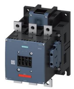
contattore di potenza, AC-3 225 A, 110 kW / 400 V AC (50 ... 60 Hz) / comando in DC UC 110-127 V contatti ausiliari 2 NO + 2 NC a 3 poli, Grandezza costruttiva S10 attacchi a sbarra azionamento: convenzionale morsetto a vite blocchetto di contatti ausiliari 2 NO + 2 NC laterale, sinistra + destra blocchetto di contatti ausiliari non rimovibile, DIN 50012
