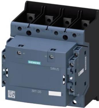
contattore, AC-1, 200 A/400 V/40 °C, S6, a 4 poli, AC/DC 100 ... 250 V, 2NO+2NC, sbarra di collegamento/ morsetti a vite
