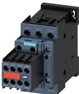
contattore di potenza, AC-3 9 A, 4 kW / 400 V 2 NO+2 NC, AC 230 V 50 / 60 Hz, con (innestato) varistore, a 3 poli, grandezza costruttiva S0 morsetti a vite blocchetto di contatti ausiliari non rimovibile
