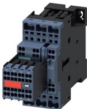
contattore di potenza, AC-3 17 A, 7,5 kW / 400 V 2 NO+2 NC, DC 24 V, a 3 poli, grandezza costruttiva S0 morsetti a molla blocchetto di contatti ausiliari non rimovibile
