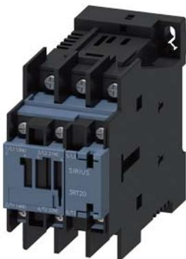
contattore di potenza, AC-3 17 A, 7,5 kW / 400 V 1 NO + 1 NC, DC 24 V con varistore integrato a 3 poli, grandezza costruttiva S0, collegamento con capocorda ad occhiello adatto per uscite PLC non ampliabile con blocchetto di contatti ausiliari .
