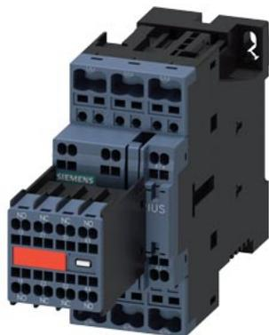
contattore di potenza, AC-3 32 A, 15 kW / 400 V 2 NO+2 NC, DC 24 V con varistore innestato a 3 poli, grandezza costruttiva S0 morsetti a molla
