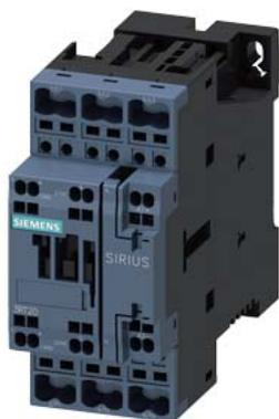
contattore di potenza, AC-3 32 A, 15 kW / 400 V 1 NO + 1 NC, DC 125 V con varistore integrato a 3 poli, grandezza costruttiva S0 morsetti a molla adatto per uscite PLC non ampliabile con blocchetto di contatti ausiliari .
