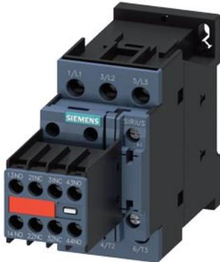
contattore di potenza, AC-3 38 A, 18,5 kW / 400 V 2 NO / 2 NC AC 230 V, 50/60 Hz a 3 poli, grandezza costruttiva S0 morsetti a vite blocchetto di contatti ausiliari non rimovibile
