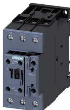
contattore di potenza, AC-3 51 A, 22 kW / 400 V 1 NO + 1 NC, AC 240 V, 50 Hz, a 3 poli, grandezza costruttiva S2, morsetti a vite
