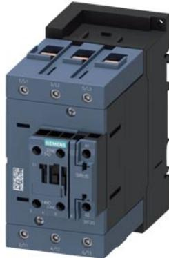
Contattore di potenza, AC-3 95 A, 45 kW / 400 V 1 NO + 1 NC, AC/DC 48-80 V a 3 poli, 3 NO, grandezza costruttiva S3 morsetto a vite varistore integrato
