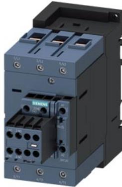
Contattore di potenza, AC-3 95 A, 45 kW / 400 V 2 NO+2 NC, AC/DC 175-280 V a 3 poli, 3 NO, grandezza costruttiva S3 morsetto a vite varistore integrato
