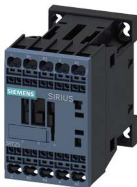
contattore di potenza, AC-3 9 A, 4 kW / 400 V 2 NO + 2 NC DC 220 V, 50 Hz/240 V, 60 Hz a 4 poli grandezza costruttiva S00 morsetto a molla
