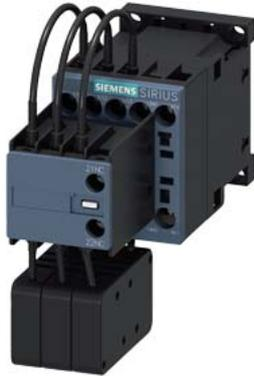
contattore per condensatore, AC-6b 12,5 kVA<sub>r</sub>, / 400 V 1 NO + 1 NC, DC 24 V a 3 poli, grandezza costruttiva S00 morsetto a vite
