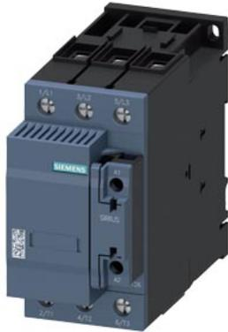
contattore per condensatore, AC-6b 75 kVAr, / 400 V 1 NO + 1 NC, AC 24 V, 50 Hz a 3 poli, grandezza costruttiva S2 morsetti a vite
