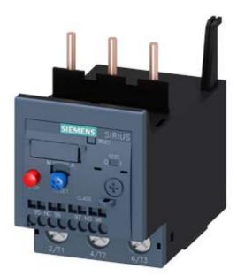
relè di sovraccarico 40... 50 A termico per protezione motore grandezza costruttiva S2, CLASS 10 montaggio su contattore circuito principale: morsetti a vite circuito ausiliario: morsetti a molla reset manuale-automatico
