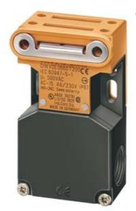
finecorsa di sicurezza con azionatore separato custodia in materiale isolante azionam. laterale e frontale contatti ad azione lenta 1NO+2NC, 3 x (M20 x 1,5) forza di estrazione 30 N L'azionatore non è compreso nella dotazione di fornitura
