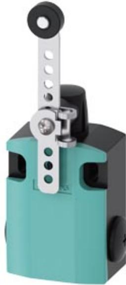
interruttore di posizione custodia in metallo larga 56 mm connessione dell'apparecchio 3x (M20x 1,5) contatti ad azione lenta 1NO/1NC attuatore a frazione di giro a destra/a sinistra impostabile, con leva in metallo regolabile in lunghezza lunga 100 mm e con accoppiamento geometrico (griglia di fori) e rotella in plastica 19 mm
