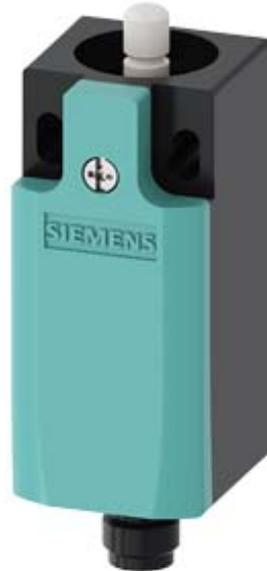
interruttore di posizione custodia in plastica, 31 mm secondo DIN EN 50047 contatti ad azione lenta 1NO/1NC con connettore M12, a 5 poli, fisso 2x LED giallo/verde DC 24 V pulsante in teflon
