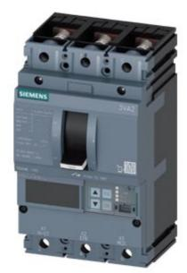
Interruttore automatico 3VA2 IEC Frame 160 Classe del potere di interruzione C Icu=110kA @ 415V a 3 poli, protezione impianto ETU550, LSI, In=160A protezione da sovraccarico Ir=63A...160A protezione da cortocircuito Isd=0,6..10x In, Ii=1,5..10x In protezione del conduttore di neutro opzionale con trasformatore di corrente, fino a 160% attacco piatto a vite
