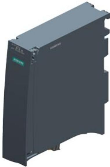
SIMATIC ET 200MP. PROFINET IO Device Modulo di interfaccia IM 155-5 PN ST per moduli di elettronica ET 200MP; fino a 12 moduli IO senza PS; fino a 30 moduli IO con PS aggiuntivo; switch a 2 porte integrato; RJ45 Shared Device; MRP; IRT  $\geq 0,25$ ms; sincronismo di clock Update FW; I&M0...3; FSU con 500ms
