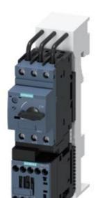
derivação de consumidor sem fusíveis, acionamento direto CA 400 V, tamanho S00 0,18...0,25 A 230 V CA conexão parafusada para sistemas de barramentos coletores de 60 mm (cumpre também o tipo de coordenação 1) tipo de coordenação 2, Iq = 150 kA 1NA (contator)
