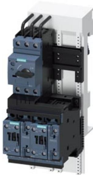
Derivação de consumidor sem fusíveis, Operação de inversão CA 400 V, tamanho S0 27,0...32,0 A 24 V CC conexão parafusada para sistemas de barramentos coletores de 60 mm (cumpre também o tipo de coordenação 1) tipo de coordenação 2, I<sub>q</sub> = 150 kA 1NA+1NF (contator)
