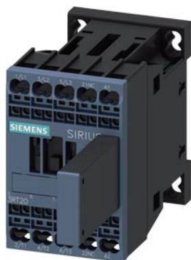
Contator de potência, CA-3 9 A, 4 kW / 400 V 1 NF, 230 V CA, 50 / 60 Hz de 3 polos, tamanho S00 conexão de mola com elemento RC colocado
