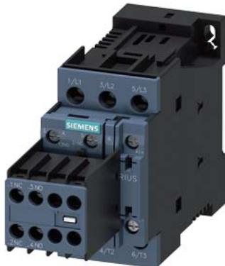
Contator de potência, CA-3 9 A, 4 kW / 400 V 2 NA + 2 NF, 24 V CC de 3 polos, tamanho S0 conexão parafusada interruptor auxiliar removível
