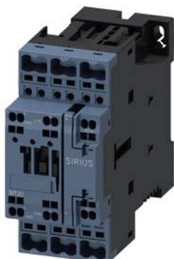
Contator de potência, CA-3 12 A, 5,5 kW / 400 V 1 NA + 1 NF, 24 V CC com capacidade de comunicação, de 3 polos tamanho S0, conexão de mola
