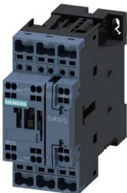
Contator de potência, CA-3 12 A, 5,5 kW / 400 V 1 NA + 1 NF, CA (50-60 Hz) acionamento CC 95-130 V CA / CC de 3 polos, tamanho S0 conexão de mola
