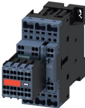
Contator de potência, CA-3 17 A, 7,5 kW / 400 V 2 NA + 2 NF, 24 V CC com combinação de diódos inserida, de 3 polos, tamanho da estrutura S0 conexão de mola interruptor auxiliar não removível
