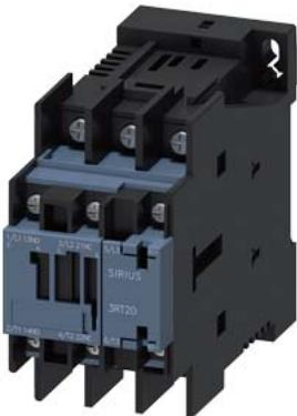
contactor de potência, CA-3 17 A, 7,5 kW / 400 V 1 NA + 1 NF, 24 V CC com varistor integrado de 3 polos, tamanho S0, conexão de terminal de cabo anular adequado para saídas CLP não expansível com interruptor auxiliar
