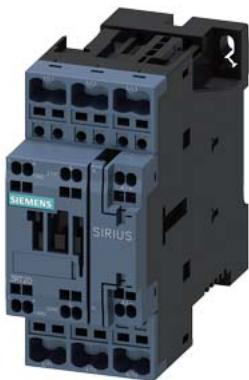
Contator de potência, CA-3 25 A, 11 kW / 400 V 1 NA + 1 NF, 110 V CC de 3 polos, tamanho S0 conexão de mola
