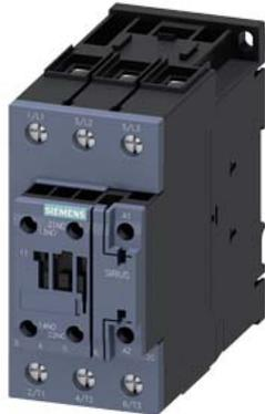
Contator de potência, CA-3 40 A, 18,5 kW / 400 V 1 NA + 1 NF, 230 V CA 50 Hz, de 3 polos, tamanho S2, conexão parafusada
