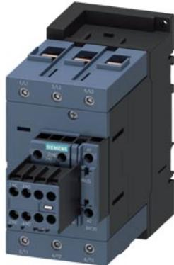
Contator de potência, CA-3 95 A, 45 kW / 400 V 2 NA + 2 NF, 42 V CA, 50/60 Hz de 3 polos, 3NA, tamanho S3 conexão parafusada
