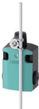
interruptor de posição carcaça metálica 56 mm de largura, ligação do aparelho 3x (M20x 1,5), 1NA/1NF contatos de aço brusca, atuador giratório direita/esquerda ajustável, alavanca de barras de alumínio 200 mm de comprimento
