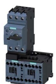
фидерная сборка без предохранителей, Реверсивный режим 400 В АС, Типоразмер S00 4,50–6,30 А 230 В перем. тока винтовой зажим для монтажа на DIN-рейку Тип координации 1, Iq = 150 kA 1 НЗ (контактор)
