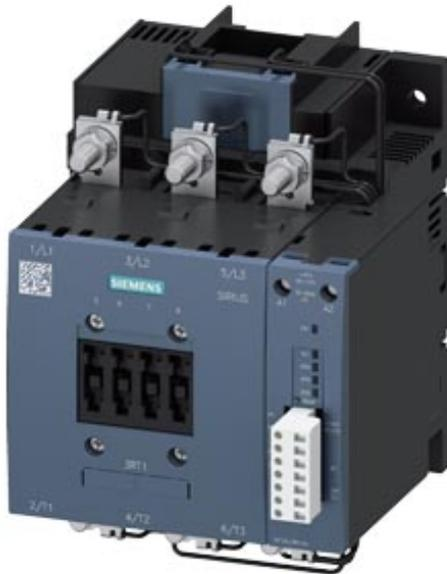
Силовой контактор, AC-3 185 A, 90 кВт/400 В AC (50–60 Гц)/режим работы по DC UC 200–277 В Вспомогательные контакты 1 НО + 1 НЗ 3-полюсн., типоразмер S6, шинные соединения Привод: электронный с интерфейсом ПЛК/SIMOCODE с оповещением об оставшемся сроке службы
