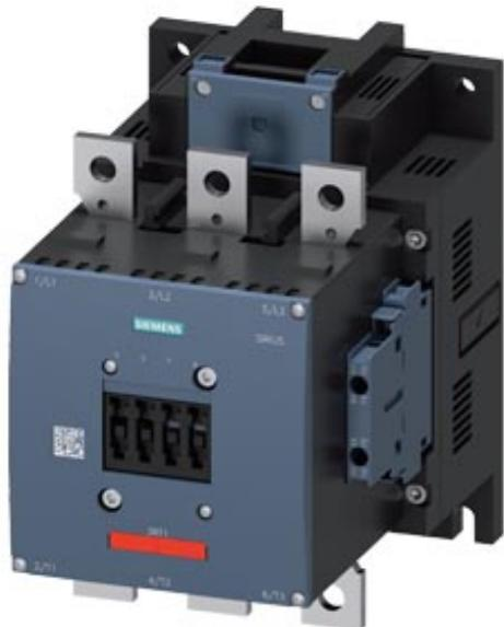
Силовой контактор, AC-3 265 A, 132 кВт/400 В AC (50–60 Гц)/режим работы по DC UC 110–127 В Вспомогательные контакты 2 НО + 2 НЗ 3-полюсн., типоразмер S10, шинные соединения Привод: стандартный винтовой зажим Блок дополнительных контактов 2 НО + 2 НЗ сбоку, слева + справа Блок дополнительных контактов, неразъемный DIN 50012
